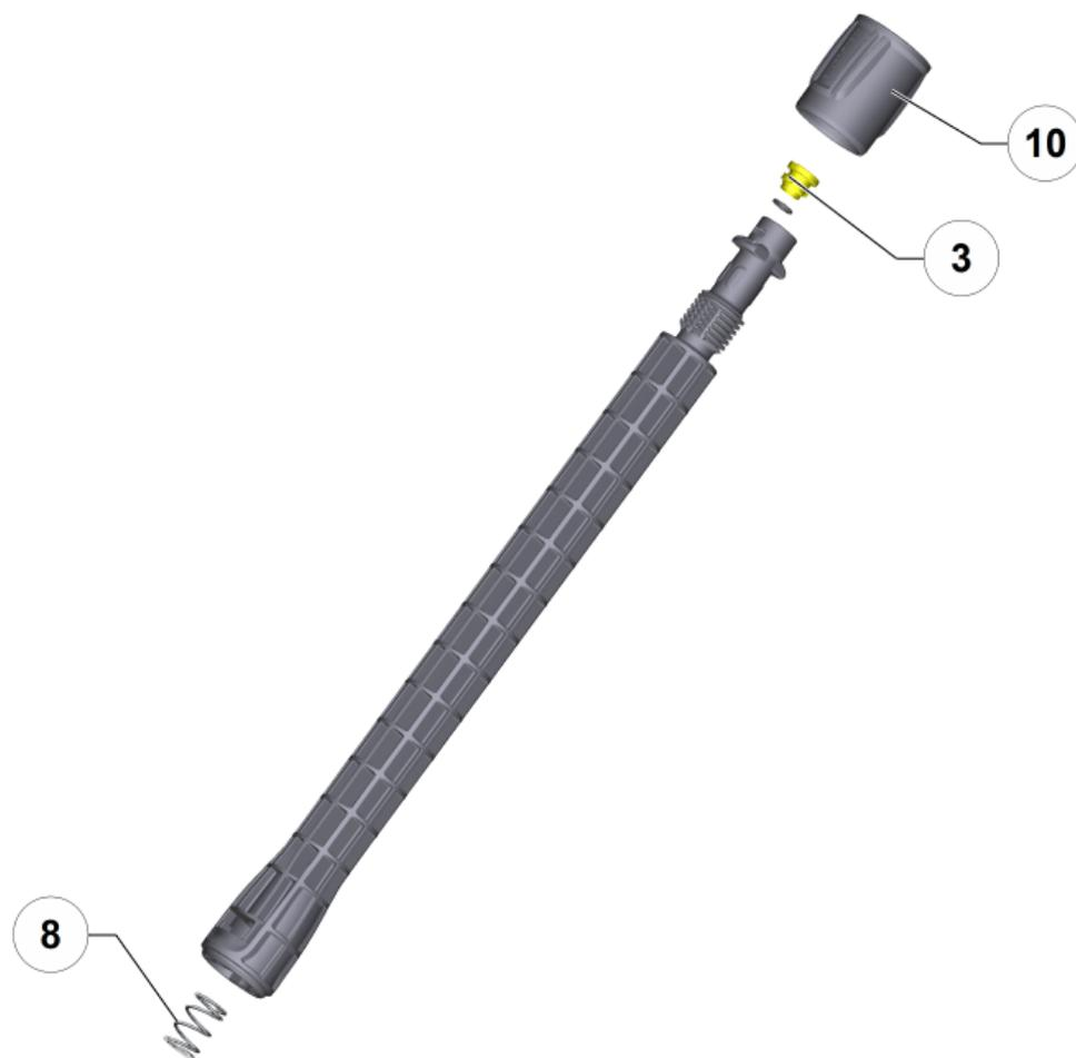
**1 1-СТУПЕНЧАТАЯ УДЛИНИТЕЛЬНАЯ ТРУБКА 0,4 М (2.643-240.0)**
