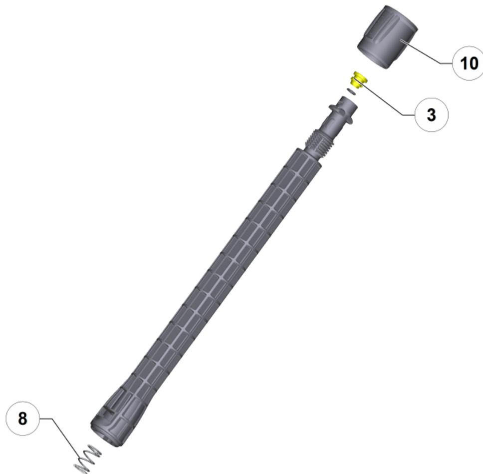
**1 1-СТУПЕНЧАТАЯ УДЛИНИТЕЛЬНАЯ ТРУБКА 0,4 М (2.643-240.0)**
